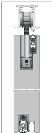
Sono inseriti nelle fresate del pannello porta e sono regolabili in discesa, in salita e in inclinazione, per una pressione omogenea su tutta la lunghezza. Il paraspiffero si alza e si abbassa ad ogni apertura e chiusura della porta.
