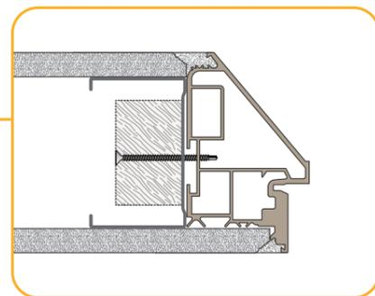
Particolare in sezione della vite sull'orditura.
