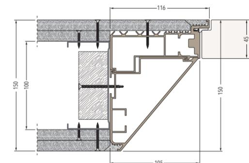
Il telaio si adatta sia alle pareti in muratura che alle pareti in cartongesso. Per le pareti in muratura le 6 zanche vengono cementate negli appositi spazi ricavati nel muro. Per le pareti in cartongesso il telaio si fissa con le viti all'orditura metallica.
