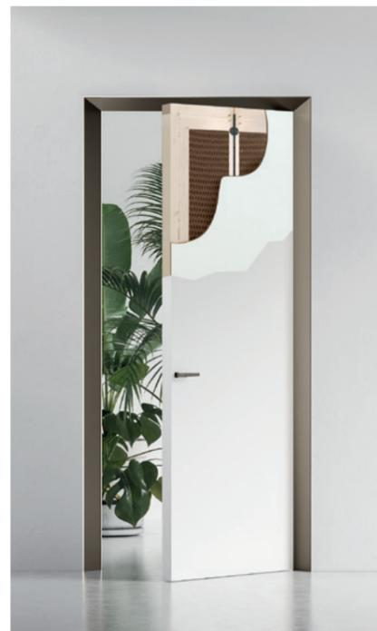
A partire da H 2000 mm il pannello porta tamburato, con doppio telaio perimetrale in legno massello e riempitivo a nido d'ape, è fornito di serie di tirante regolabile per mantenere il pannello in tensione nel tempo ed evitare spancamenti.
