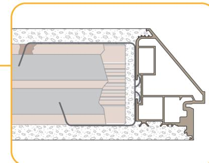
Particolare in sezione della zanca di ancoraggio.
