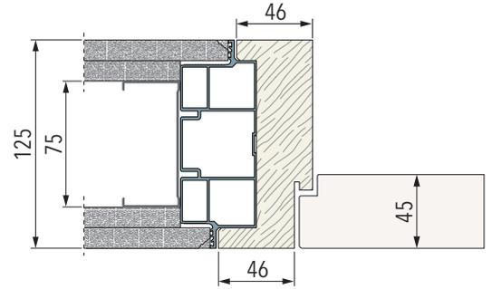
Lastra singola: Parete Finita 125 mm - Orditura 100 mm | Telaio da 125 mm
